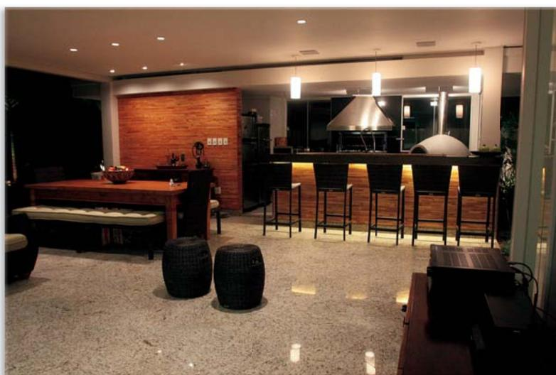
Onde o pé-direito era mais baixo, com 2,85 metros, foram instalados embutidos com visor de vidro temperado translúcido – tido pelo lighting designer como fundamental para uma luz agradável – com lâmpadas halógenas de 35W, 36° de abertura e a 3100K. Além disso, também no forro, embutidos orientáveis com o mesmo tipo de lâmpadas servem para iluminar os quadros nas paredes.
